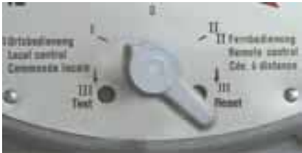
图 M-3: 一体化控制单元上的选位开关
