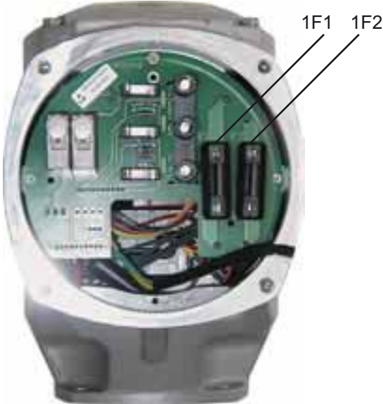
图 V1: 信号板和控制单元板上的保险丝
