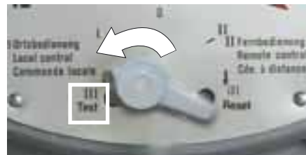
图 M-7: 一体化控制单元上的选位开关
