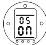
此功能可用**+**或**-**键将在屏幕下半部分显示改为[OF]，使其关闭。如果不使用此功能，重要的是在电源掉电、且电池电量不足的情况下，不要用手轮操作执行器。此时可将执行器的手动/自动切换手柄锁在自动位置，以防止手动操作。
