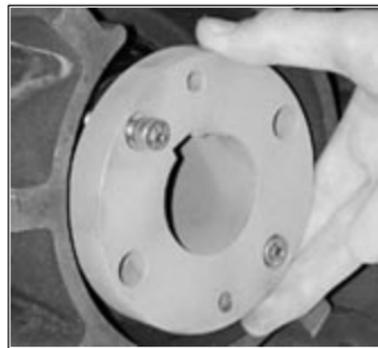
图 17 B3/B4型驱动轴套的安装
