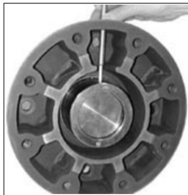
图 15 上紧止挡圈的定位螺栓
