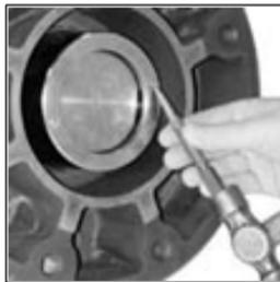
图 9 拆卸止挡圈
