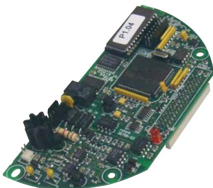
IQ 现场控制模块印刷电路板
