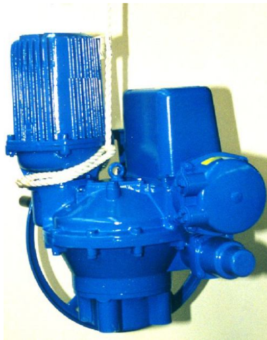
图1: 通过吊车对执行器搬运
