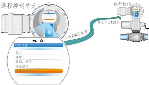
图：远程控制单元控功能原理
